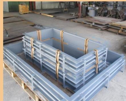
➔ В 2018 году запущено производство линзовых компенсаторов, компенсирующих температурные удлинения круглых и прямоугольных газоздухопроводов (ПГВУ), круглых трубопроводов для воды и пара (ОСТ) тепловых электрических станций. На нашем оборудовании выполняется качественная и аттестованная формовка линз в соответствии с стандартами ПГВУ и ОСТ. Современное, аттестованное сварочное оборудование обеспечивает надежное и герметичное соединение линзы.
